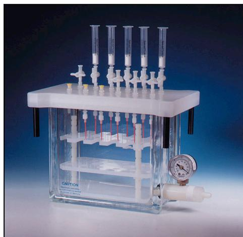
**FIGURE 25** : Collecteur de type extraction en phase solide.
