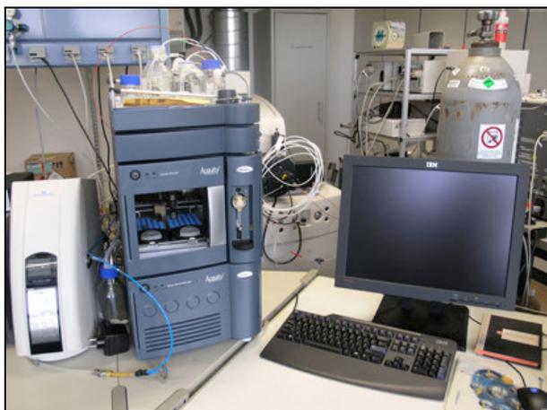
**FIGURE 28 :** *Appareil de chromatographie liquide ultra performante.*
