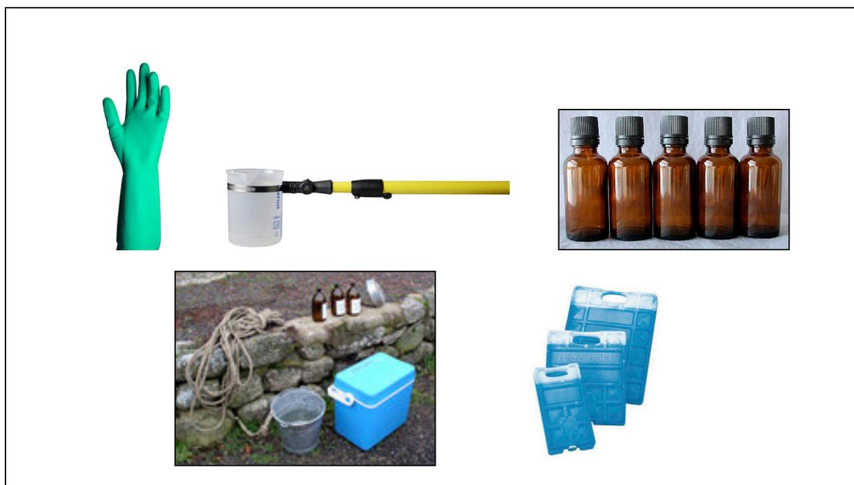
**FIGURE 24 :** *Principaux équipements nécessaires aux prélèvements.*
