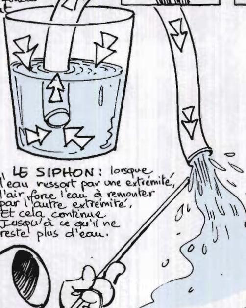
**LE SIPHON:** lorsque l'eau ressort par une extrémité, l'air force l'eau à remonter par l'autre extrémité. Et cela continue jusqu'à ce qu'il ne reste plus d'eau.
